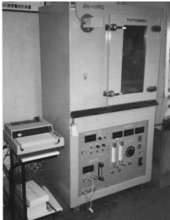
JIS C 0081 (ASTM E662 (NBS)) 発煙試験装置
