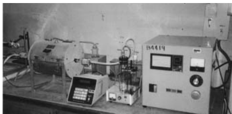
JIS C 3666-2によるpH測定試験装置
